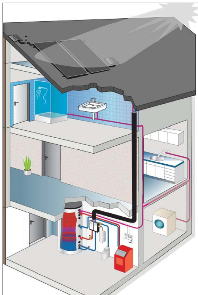
Рис. 2-2 Схематическое изображение солнечного коллектора для приготовления горячей воды
