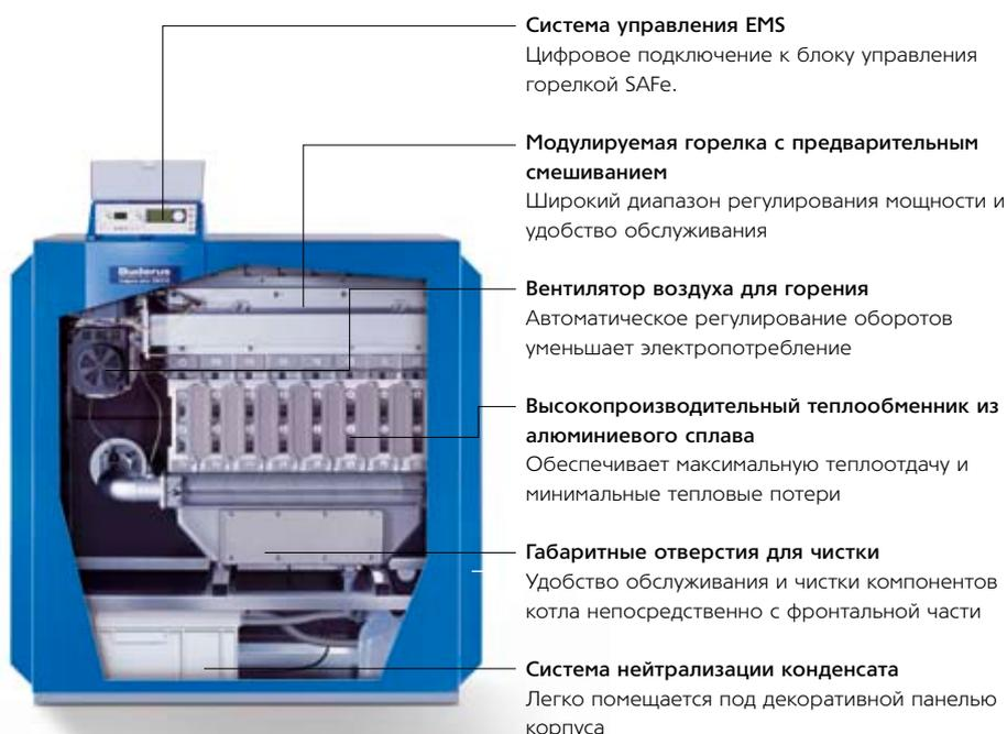
Благодаря компактным габаритам котла и возможности использования специальных комплектов для обвязки котла и систем дымоотведения, оборудование занимает удивительно мало места и идеально подходит для установки в помещениях с ограниченным пространством.
